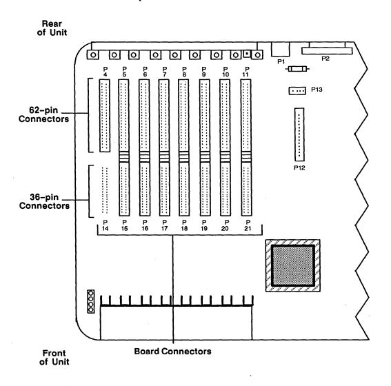
Figure 2-2. DS3000 and DS4000 Bus Connectors (Newer Version)
