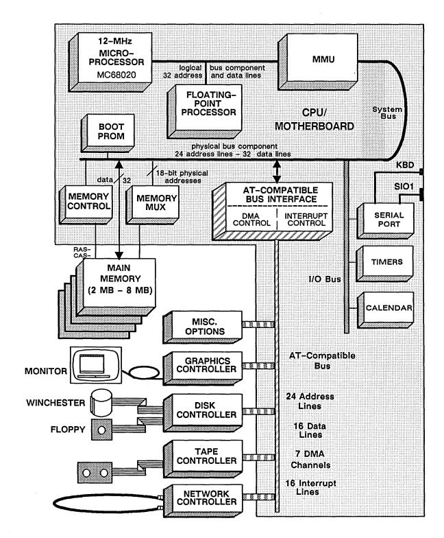
Figure 1-1. DS3000 Functional Block Diagram
