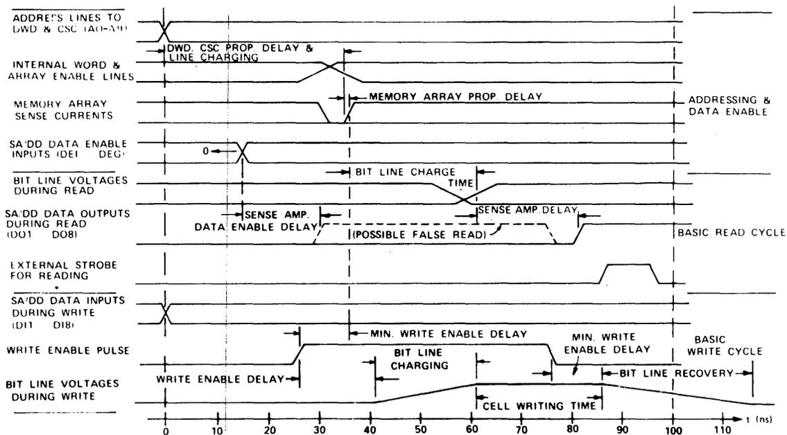
Figure 14—Timing diagram - 8192 bit MOS stack memory
