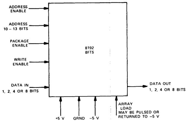
Figure 1—Block diagram 8192 bit module
