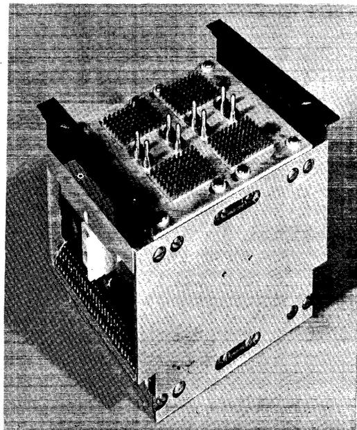
Figure 14—The stack module
