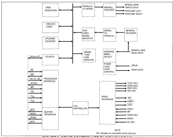
FIGURE 3. DRIVE CONTROLLER BLOCK DIAGRAM
