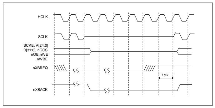
Figure 5-3. S3C2440A nXBREQ/nXBACK Timing Diagram
