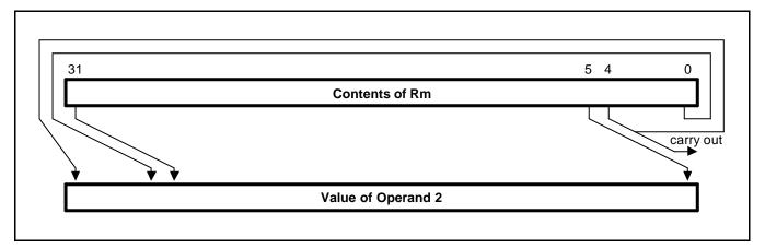
Figure 3-9. Rotate Right
