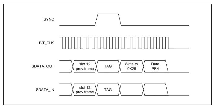
Figure 24-7. AC97 Powerdown Timing Diagram
