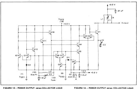
FIGURE 12 - CIPCUIT SCHEMATIC USED FOR COLLECTOR OUTPUT OPERATION
