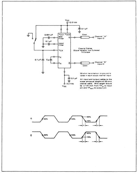
FIGURE 2 - AC TEST CIRCUIT AND WAVEFORMS
