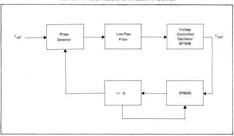
FIGURE 9 - TYPICAL FREQUENCY SYNTHESIZER APPLICATION
