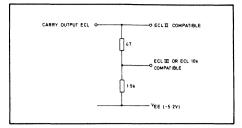
Fig. 3 ECL III/ECL 10000 interfacing
