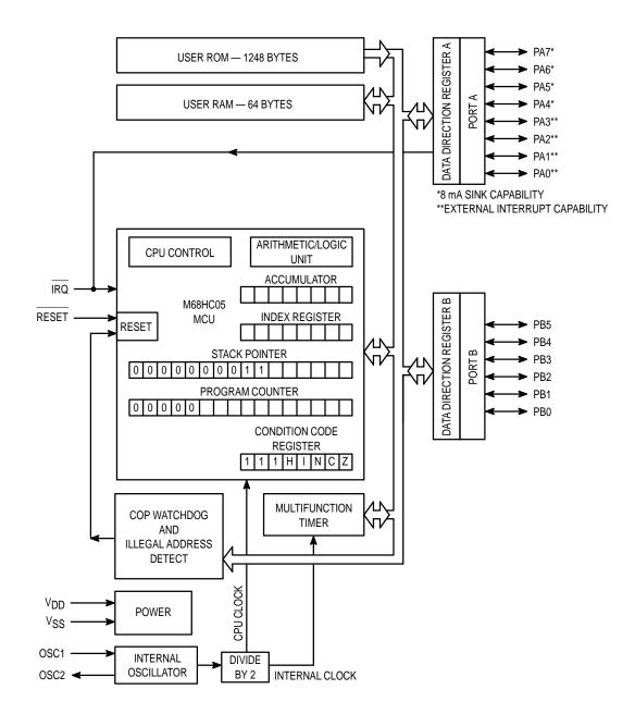
Figure 1. MC68HC05J1A Block Diagram
