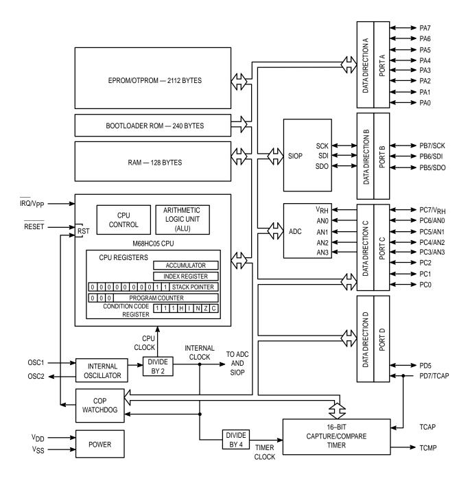
Figure 2. MC68HC705P9 Block Diagram
