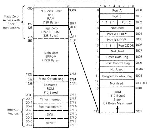
FIGURE 4 - MC68705P5 MCU MEMORY CONFIGURATION
