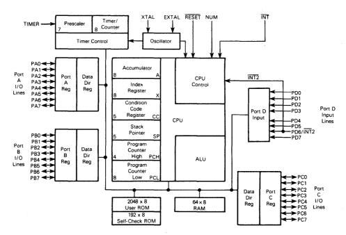
Figure 1-2. MC6805U2 Block Diagram
