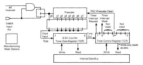
Figure 5-1. MC6805R2/MC6805U2 Timer Block Diagram
