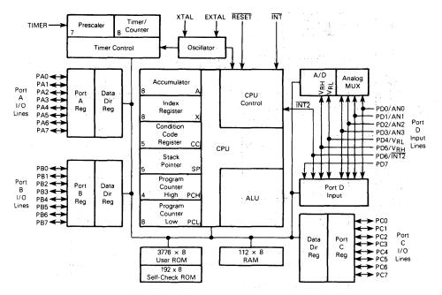
Figure 1-3, MC6805R3 Block Diagram
