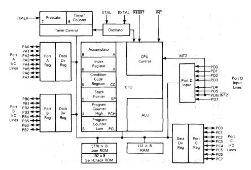
Figure 1-4. MC6805U3 Block Diagram
