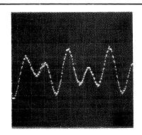
Figure 6 - TYPICAL DUAL TONE WAVEFORM (ROW 1, COL.1)
