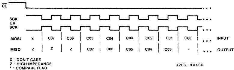
Fig. 4 - Control byte.
